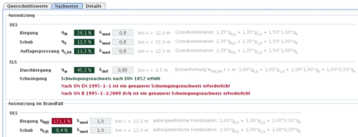
In der Karteikarte „Ausnutzung“ ist der Verlauf der maßgebenden Ausnutzungsgrade über den Träger dargestellt. Hier wird auch der Bereich markiert, in dem die Ergebnisse von der exakten Lösung abweichen können.
